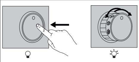
**Освещение** - Для включения освещения нажмите на ручку и отпустите, чтобы она поднялась.
