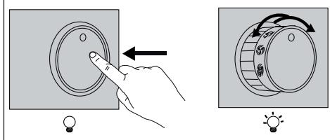
**Oświetlenie** - włącza się przez naciśnięcie pokrętła i zwolnienie go w taki sposób, aby wyszło na zewnątrz.
