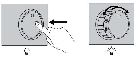
**Lumini** – Pentru a aprinde luminile, apăsați butonul rotativ și eliberați-l astfel încât acesta să iasă din locașul său.
