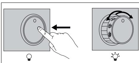
**Luces** - Para encender las luces, presione la perilla y suéltela para que salga de su alojamiento. Para apagar las luces, vuelva a presionar la perilla hacia adentro, colocándola en la posición de interruptor apagado.
