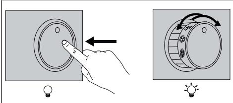
**Освітлення** - Щоб увімкнути освітлення, натисніть на дисковий регулятор і відпустіть його. Він має висунутися з корпусу. Щоб вимкнути освітлення, натисніть на дисковий регулятор ще раз, повертуючи його на місце в корпусі.
